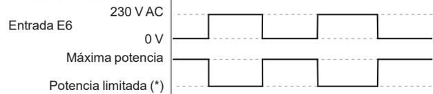
(\*) Limitación de corriente definida durante la configuración de la estación de carga inicio diferido
