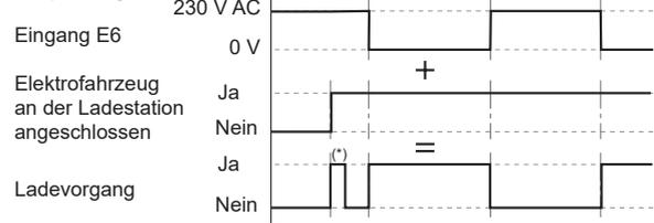
(\*) Initialisierung der Kommunikation zwischen Elektrofahrzeug und Ladestation (30 Sekunden)
